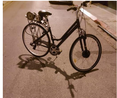
Imatge: prototip final de la bicicleta elèctrica sense bateries
